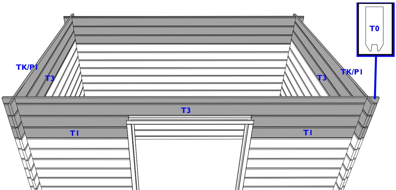
Wenn es zu Unterschiedliche höhen kommt, Kontrolliert man zuerst ob jedes Brett gut anschließt. Um Unterschiedlichkeiten zu eliminieren (Detail A) sorgen Sie dafür das das oberste Brett gleiche auf Höhe kommt und schraube diese zusammen (Detail B). Jetzt sorgt man dafür durch jedes Brett eins nach dem andern ein bisschen hoch zuschieben den Spalt gleichmäßig über alle Bretter zu verteilen (Detail D).
