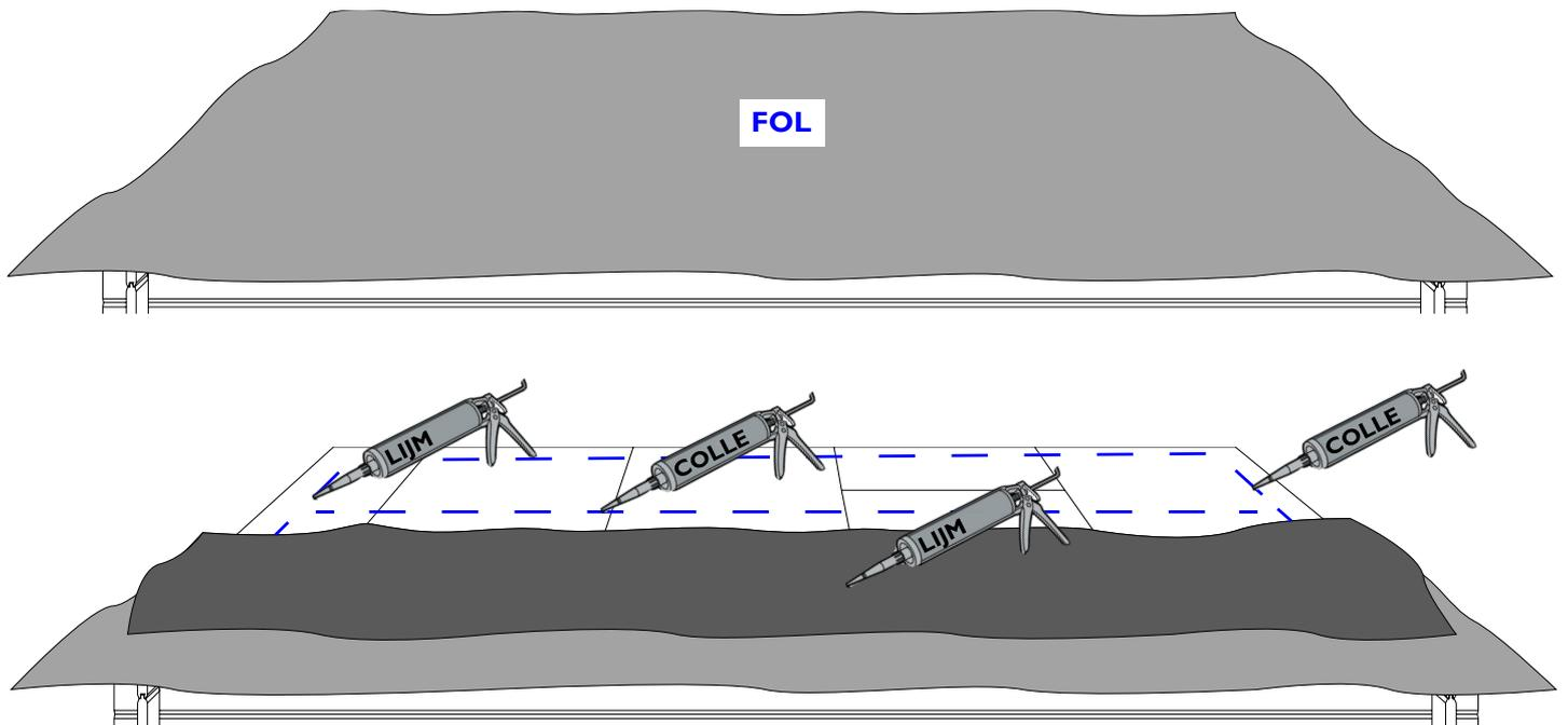
9. Montieren der Leiste FSL an Vorderseite und an die Seiten. Die Folie wird jetzt über die OSB Platte gezogen so das sie zwischen Leiste und Dachplatten fest sitzt.
